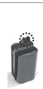
3. Ouvrez le couvercle de la batterie, trouvez la ligne de connexion de la batterie, appuyez sur le clip du connecteur, tirez et retirez la batterie.
